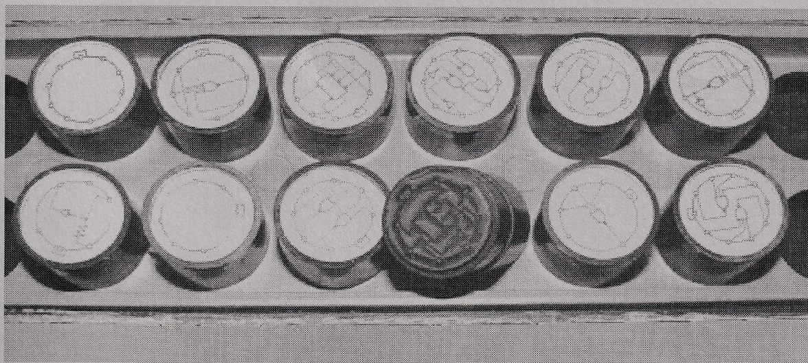
SGS Fairchild-etuiet med 12 stycken MLE-stämplor för att markera funktion och anslutningar.
