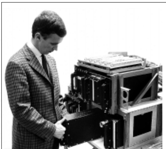
Fig. 5. Datamaskin CK37. Installation i flygplansrack.
