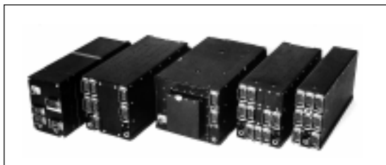
Fig. 4. De fem apparatenheterna som utgör datamaskinen CK37.
