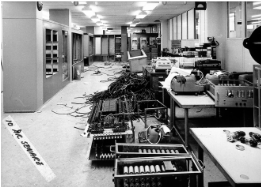
När Sara skrotades 1967 efter tio års tjänst, skingrades alla delarna utom kärnminnet (hitom sladdhögen i bilden), som förvaras i Datasamuseet på Linköpings Tekniska Högskola.
